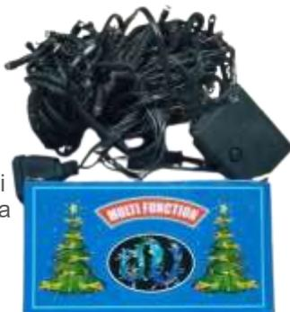
**Svjetlosni lanac Yilbasi Isigi** predstavlja rizik od strujnog udara i požara jer je dužina napojnog kabla manja od minimalno dozvoljene i napojni kabl ne ispunjava zahtjeve električne izdržljivost.
