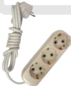
**Produžni kabl DSDM0728006** predstavlja rizik od strujnog udara jer se može rastaviti alatom opće namjene i ima sredstvo za pričvršćenje na zid koje omogućava pristup dijelovima pod naponom.
