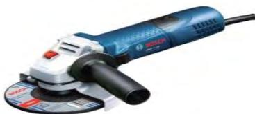
Ručne brusilice spadaju u grupu ručnih električnih alata koji se koristi za obradu - brušenje i poliranje drveta ili metala. Mogu se pokretati elektromotorom, benzinskim motorom ili kompresovanim zrakom. Motor pokreće glavu zupčanika na kojem je montiran abrazivni disk, koji se može zamijeniti kada se istroši.
