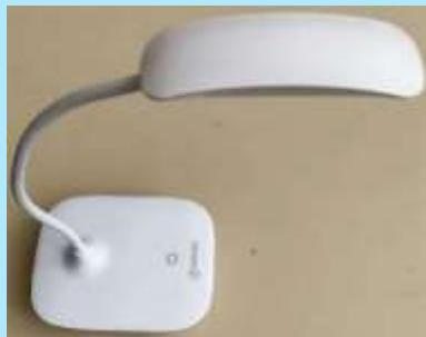
**Prenosna električna svjetiljka TX518379** predstavlja rizik od požara i strujnog udara jer je površina poprečnog presjeka provodnika u kablu manja od minimalno dozvoljene.
