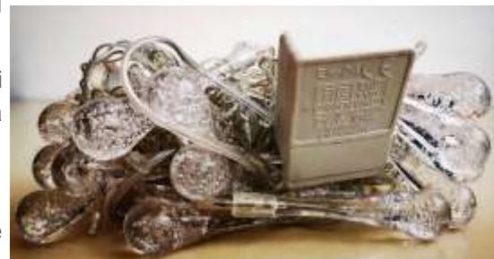
Najčešći nedostaci utvrđeni tokom laboratorijskih ispitivanja svjetlosnih lanaca, odnosili su se na nedozvoljenu klasu izolacije i nedovoljnu dužinu kabla između utikača i prve svjetiljke.
