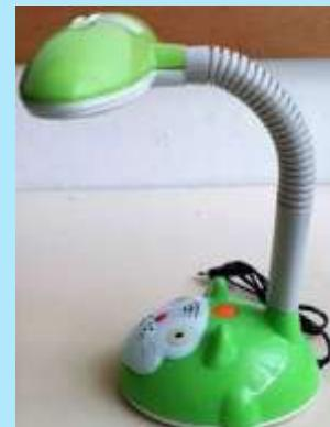
**Prenosna električna svjetiljka Rola DY15256** predstavlja rizik od požara i strujnog udara jer je površina poprečnog presjeka provodnika u kablu manja od minimalno dozvoljene i tip utikača ne odgovara standardima u Bosni i Hercegovini.
